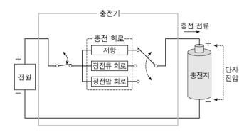
충전에 사용하는 충전기의 전원 전압은 충전지의 공칭 전압보다 높은 전압을 사용하고 충전지로 유입되는 전류를 저항으로제한한다. 그러나 충전이 이루어지면서 충전지의 단자 전압이상승하여 유입되는 전류의 세기가 점점 줄어들게 된다. 그러므로이를 막기 위해 충전기에는 충전 전류의 세기가 일정하도록하는 정전류 회로가 사용된다. 또한 정전압 회로를 사용하기도하는데, 이는 회로에 입력되는 전압이 변해도 출력되는 전압이일정하도록 해 준다. 리튬 충전지를 충전할 경우, 정전류 회로를사용하여 충전하다가 만충전 전압에 이르면 정전압 회로로 전환하여 정해진 시간 동안 충전지에 공급하는 전압을 일정하게 유지함으로써 충전지 내부에 리튬 이온이 고르게 분포될 수 있게한다.
